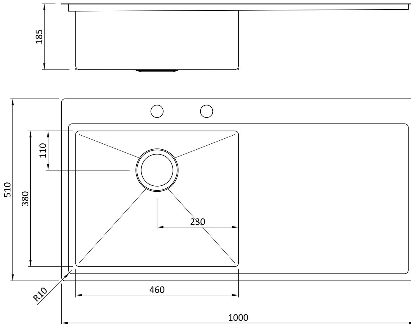
Perçages diamètre 35 mm pour les vidages automatiques, mitigeurs et distributeurs de savon BRADANO.
